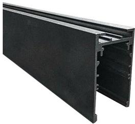
Binario magnetico costituito da un profilo di alluminio estruso con un sistema magnetico per il fissaggio istantaneo degli apparecchi illuminanti. Lunghezze disponibili di 0.5, 1, 1.5, 1, 2 metri. - Voltaggio DC24V - Corrente massima 16A per binario - Connessione massima 20m - Temperatura di esercizio -10°C+50°C.
