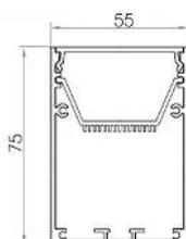
**Apparecchi LED** per montaggio a plafone o a sospensione a fascio simmetrico con elevata efficienza energetica. Adatti per montaggio singolo o in fila continua. Corredati di diffusore in policarbonato con finitura opale.
